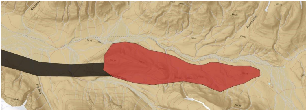
Figur 8: Skisse av mulig areal for utbygging av sol- og/eller vindkraftverk i Adventdalen. Rød skravur indikerer en initiell vurdering av egnet område for solkraftverk og vindkraftverk. Sort skravur indikerer areal vurdert for både kraftledning og veiatkomst.
