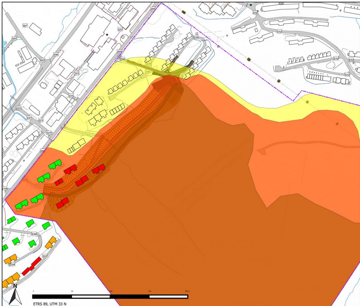
Figur 4: Beregnede faresoner etter sikring med fangvoll og støtteforbygninger. Fargekodene på bebyggelsen angir kun tidspunkt for planlagt sanering. All bebyggelse innenfor rød og oransje sone må tas ut av bruk.
