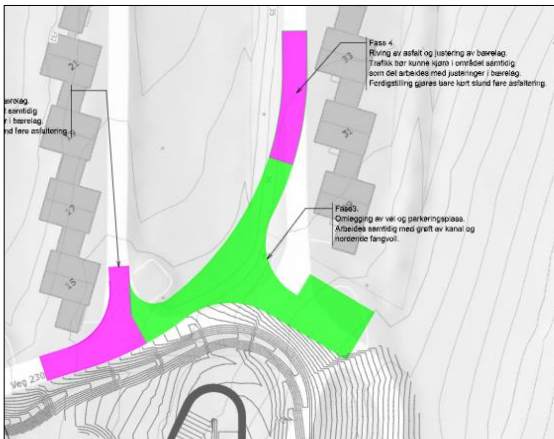
Figur 22: Omlegging av vei 232. Innenfor grønt areal legges veien om. Innenfor de fiolette arealene gjøres det mindre justeringer av høyde og avgrensning.
