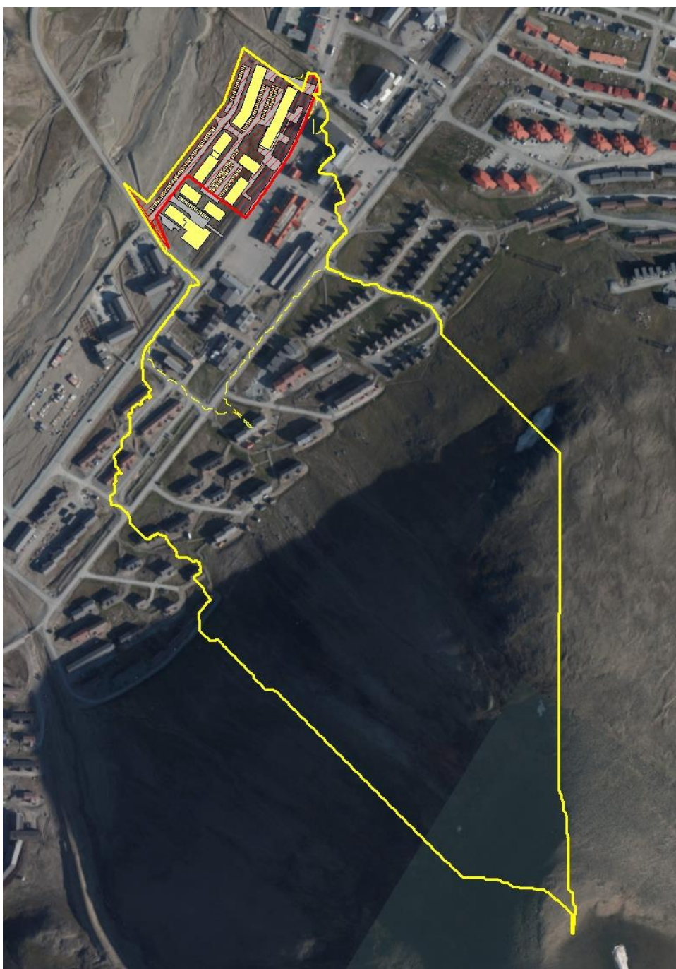
Figur 2: Nedslagsfelt beregning for situasjon hvor stikkrenner er aktive (stiplet linje) og situasjon hvor alt vann renner på overflate, dvs. stikkrenner kan ansees som tette (tjukk, heltrukken linje).
